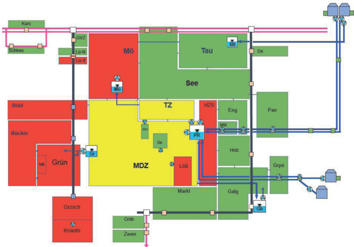
Bild 3: Schadensausmaß nach 24 Stunden ohne Aktivierung von Gegenmaßnahmen
